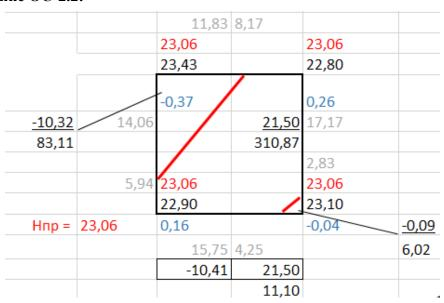
1. Определяем проектную отметку горизонтальной площадки, как среднеарифметическое значение абсолютных отметок точек вершин квадрата:
